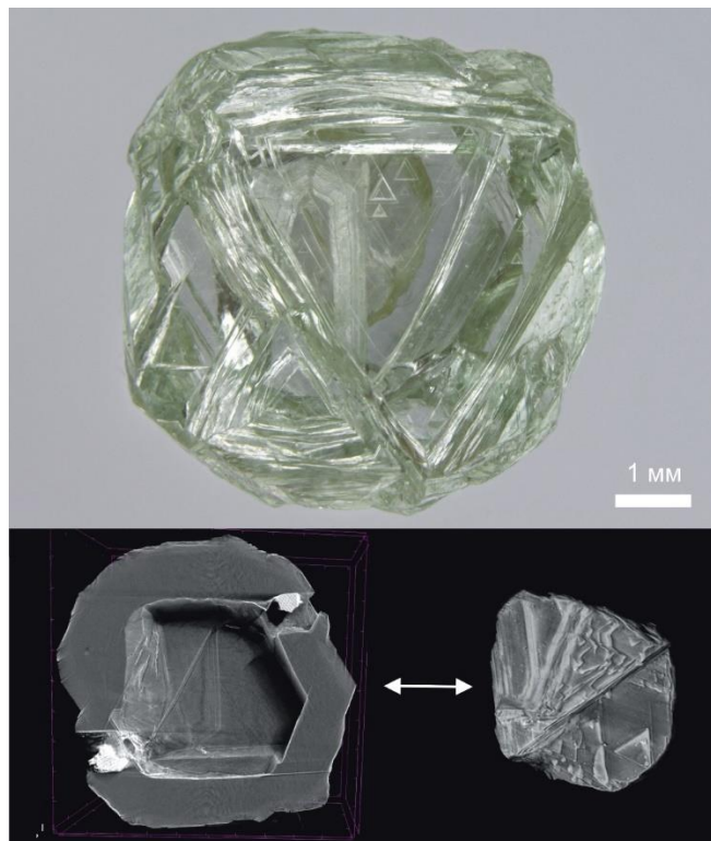
Рисунок 1 – Алмаз «Матрешка» и совмещение отпечатков индукционной штриховки на внутренней поверхности полости и содержащемся в ней алмазе для восстановления первоначальной позиции алмазного включения. Рентгеновский микротомограф.
