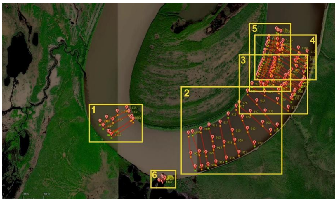
Рисунок 1 – Расположение участков исследований: 1 – площадная съемка АБ 50 МГц; 2 – площадная съемка АБ-50 МГц; 3 – площадная съемка АБ-50 МГц; 4 – площадная съемка АБ-250 МГц; 5 – площадная съемка продольными профилями АБ-250 МГц; 6 – экспериментальные исследования на руч. Чукучанка.
